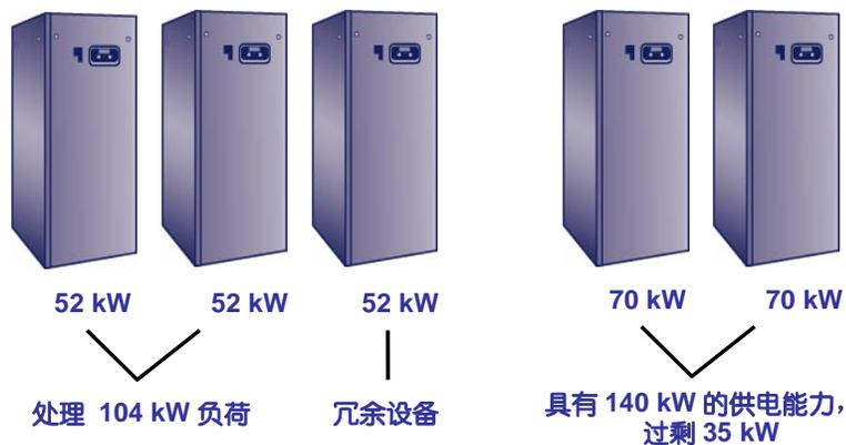
还应注意冗余和制冷能力过剩之间的区别。对于一个负荷为 70 kW 的工作室来说，3 个 52 kW 系统或 4 个 35 kW 系统就可提供冗余。要将待机设备作为冗余设备，需要根据运行时间进行设备运行轮换，并且需要提供自动启动功能的控制界面。
